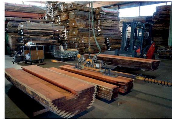
links: Tischplatte wird mittels Vakuumkan auf den Frästisch gehoben
